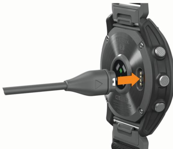
2 Conecta el otro extremo del cable a un puerto del ordenador USB-A o USB-C® o al adaptador de CA, dependiendo del cable suministrado con el reloj.
